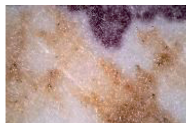
図9 MFS 上の Fe 粒子と ATG の反応の様子 (40 分後)
