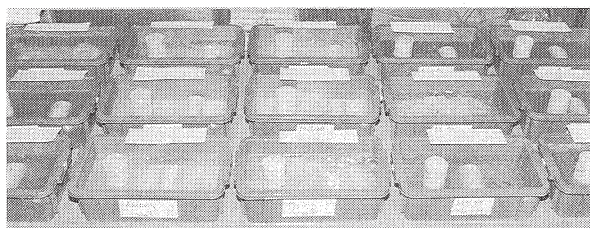
写真16 各種溶液に浸漬中の供試体
