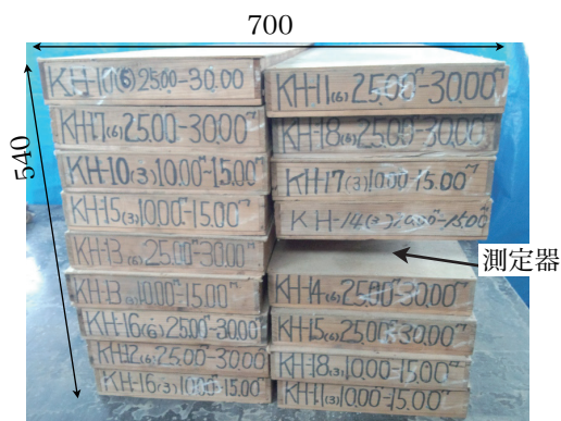
写真4(a) コア箱による囲み法
